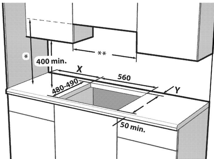
\* Hauteur minimale pour l'extracteur telle que recommandée dans le manuel d'instructions de l'extracteur. Si ce n'est pas recommandé dans le manuel d'instructions de la hotte, cette hauteur doit être d'au moins min.650 mm.
