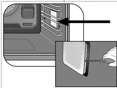
3. Soulevez le couvercle de protection en verre de la lampe à l'aide d'un tournevis.
