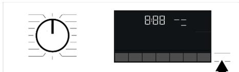
Se il livello dell'acqua nella macchina non è adeguato, premendo il pulsante Avvio/Pausa, il blocco dello sportello non potrà essere disattivato e il simbolo del blocco sportello resterà acceso sul display.
