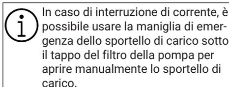
In caso di interruzione di corrente, è possibile usare la maniglia di emergenza dello sportello di carico sotto il tappo del filtro della pompa per aprire manualmente lo sportello di carico.
