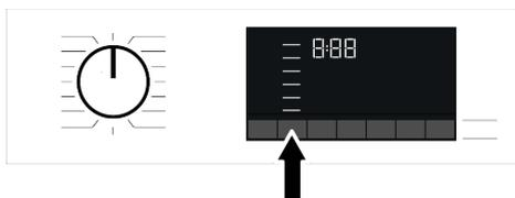
Quando si seleziona un nuovo programma, la velocità di centrifuga consigliata del programma selezionato è visualizzata sull'indicatore velocità di centrifuga. È possibile ta-
