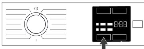
Nachdem ein Programm ausgewählt wurde, wird die empfohlene Schleuderdrehzahl des gewählten Programms in der Anzeige Schleuderdrehzahl dargestellt. Möglicherweise ist die empfohlene Schleuderdrehzahl nicht die Maximalschleuderdrehzahl, die beim aktuellen Programm ausgewählt werden kann.
