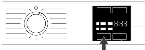
Quando si seleziona un nuovo programma, la velocità di centrifuga consigliata del programma selezionato è visualizzata sull'indicatore velocità di centrifuga. È possibile tale valore consigliato non sia la velocità di centrifuga massima selezionabile per il programma corrente.
