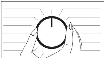
Program sa zruší po nastavení Ovládača výberu programu na iný program alebo pri vypnutí a zapnutí práčky týmto tlačidlom.
