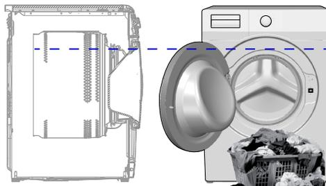
V programe prania 4 kg a 4 kg sušenia sa odporúča naplniť pračku až do úrovne uvedenej vyššie, aby sa dosiahli ideálne podmienky sušenia (pri otvorení nakladacích dveriek môžete vidieť šípku úrovne).
