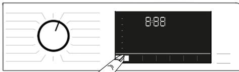
Vždy, keď zvolíte nový program, na indikátore teploty sa zobrazí odporúčaná teplota pre daný program. Je možné, že hodnota odporúčanej teploty nie je maximálna teplota, ktorá sa dá vybrať pre aktuálny program.
