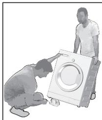
Nakloňte prístroj dozadu, aby ste odstránili obalovú výstuž. Obalovú výstuž odstráňte ťahaním pásky.
