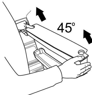
3. Retire y limpie la tapa del depósito de agua.
