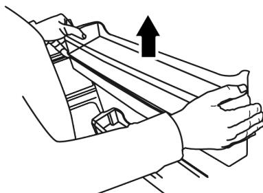
2. Sujete ambos lados del tanque de agua y retire a un ángulo de 45°.
