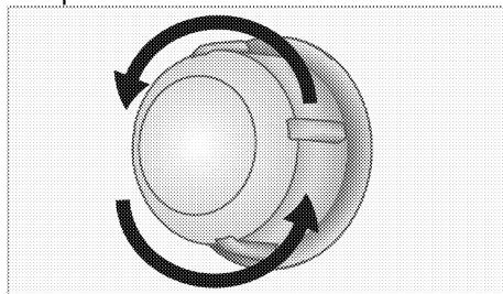
3. Если в вашей духовке используется лампа типа (A), показанная на рисунке ниже, поверните ее в соответствии с рисунком, чтобы извлечь ее и заменить. Если используется лампа типа (B), потяните и извлеките ее, как показано на рисунке, и замените.
