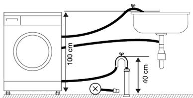
4. Para evitar que a água usada volte a entrar no produto e para assegurar um escoamento fácil, não submergir a extremidade da mangueira na água usada ou não inserir a mesma no escoamento mais de 15 cm. Se for demasiado comprida, cortá-la.
