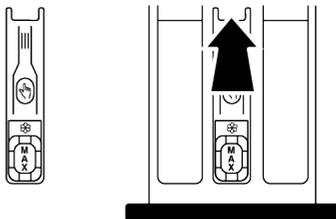
1. Premir a parte marcada do sifão dentro do compartimento do amaciador e depois puxar a gaveta em direção a si para a retirar.
