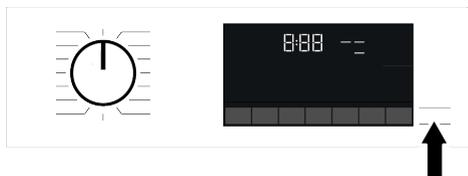
Se o nível de água na máquina não for adequado quando premir o botão Iniciar/Pausa, o bloqueio da porta não pode ser desativado e o símbolo de bloqueio da porta no visor mantém-se aceso.
