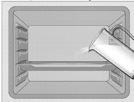
3. Réglez le four en mode de nettoyage facile à la vapeur et faites-le fonctionner à 100 °C pendant 25 minutes.
