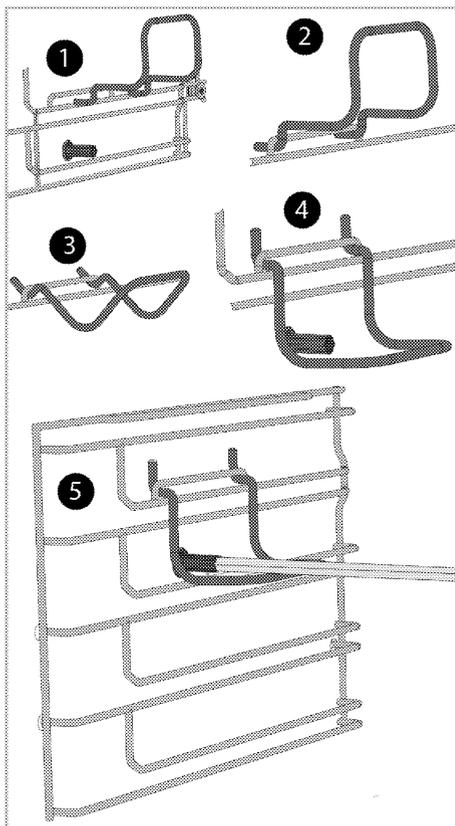
4. Placez le bord pointu de la broche dans la fente rotative du côté gauche à l'intérieur du four.
