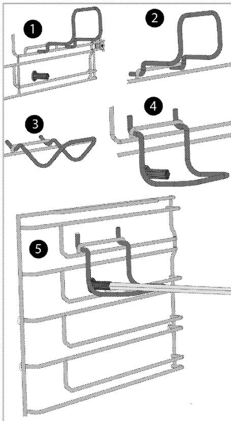
Placez le bord pointu de la broche dans la fente rotative du côté gauche à l'intérieur du four. Si votre broche dispose d'un manche en plastique, retirez-le. Comme le montre la figure, accrochez l'autre bord de la broche au crochet. Assurez-vous que la broche est bien fixée avec le crochet, comme sur la figure.
