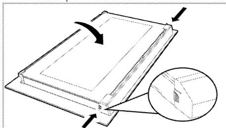
2. Tirez vers vous le composant en plastique fixé sur la partie supérieure de la porte avant en appuyant simultanément sur les points de pression des deux côtés du composant et retirez-le.
