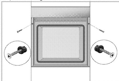
3. Veillez à ce que les vis soient serrées tel que requis et que le four ne bouge pas. Le four pourrait basculer pendant son fonctionnement si son installation n'est pas effectuée conformément aux instructions et si les vis ne sont pas serrées tel que requis.
