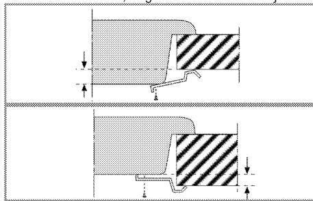
**i** Pliid paigaldamisel kapi peale tuleb paigaldada ka riil, mis eraldab kappi pliidist: vt eespool toodud joonist. Sisseehitatud ahju kohale paigaldamisel ei ole seda vaja.
