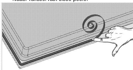
3. Kinnitage paigaldusvedrud, kruvides need läbi korpu alumises osas olevate avade, nagu joonisel näidatud.
