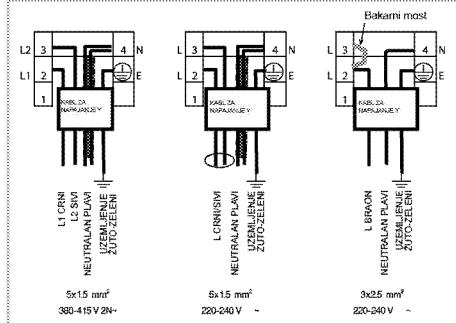
2. Za jednofazno povezivanje, žice treba povezati na sledeći način:
