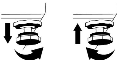
**Za vertikalno podešavanje vrata,** otpustite pričvrсни vijak na dnu Okrenite vijak za podešavanje prema položaju (u smjeru kazaljke na satu/u smjeru
