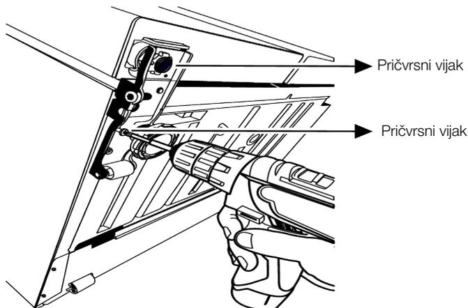
**Za horizontalno postavljanje vrata,** otpustite pričvrсни vijak na dnu Otpustite pričvrсну maticu na vrhu. Okrenite vijak za podešavanje na stranu prema položaju (u
