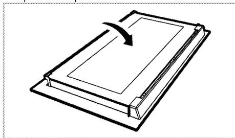
2. Tirare verso di sé e rimuovere la parte in plastica installata sulla sezione superiore dello sportello anteriore.
