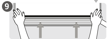
Montirajte unutrašnju jedinicu
