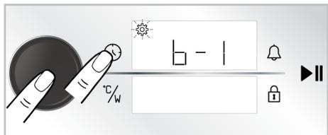
4. Stellen Sie den gewünschten Ton ein, indem Sie den Bedienknopf nach rechts/links drehen.
