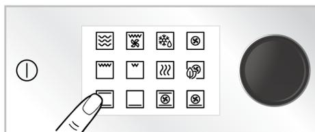
3. Auf dem Display erscheint die vordefinierte Temperatur für die von Ihnen gewählte Betriebsfunktion. Um diese Temperatur zu ändern, drücken Sie einmal auf den Bedienknopf des Backofens oder berühren Sie die Taste **°C** und drehen Sie den Bedienknopf des Backofens nach rechts/links.
