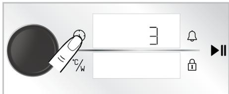
2. Drehen Sie den Bedienknopf des Backofens nach rechts/links, bis „b-1“ oder „b-2“ auf der Timer-/Daueranzeige erscheint.
