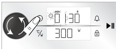
8. Stellen Sie die Backzeit in Minuten ein, indem Sie den Bedienknopf nach rechts/links drehen.
