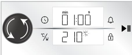
5. Bestätigen Sie die eingestellte Temperatur durch Berühren der Taste °C/W.
