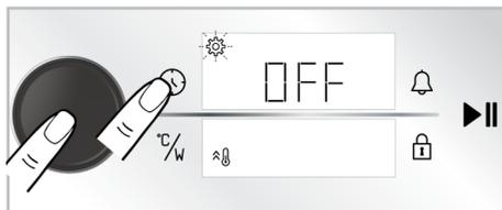
4. Schalten Sie die Einstellung „AUS“ auf dem Display auf „EIN“, indem Sie den Backofenregler nach rechts/links drehen.
