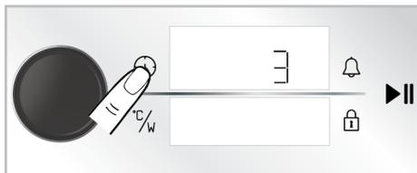
2. Aktivieren Sie das Timerfeld, indem Sie einmal auf den Bedienelementknopf des Backofens drücken oder einmal die Taste berühren.
