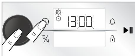
4. Stellen Sie die Minute ein, indem Sie den Backofenregler nach rechts/links drehen. Bestätigen Sie die Einstellung, indem Sie einmal auf den Bedienelementknopf des Backofens drücken oder einmal die Taste berühren.
