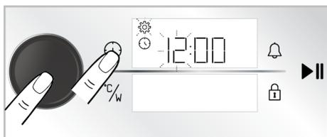
3. Stellen Sie die Uhrzeit ein, indem Sie den Bedienelementknopf des Backofens nach rechts/links drehen und aktivieren Sie
