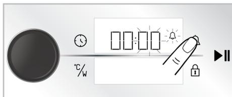
2. Stellen Sie zunächst die Minuten ein, indem Sie den Drehknopf des Backofens nach rechts/links drehen, und aktivieren Sie das Timerfeld durch einmaliges Berühren der Taste
