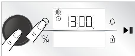
4. Stellen Sie die Minute ein, indem Sie den Backofenregler nach rechts/links drehen. Bestätigen Sie die Einstellung, indem Sie einmal auf den Bedientopf des Backofens drücken oder einmal die Taste
