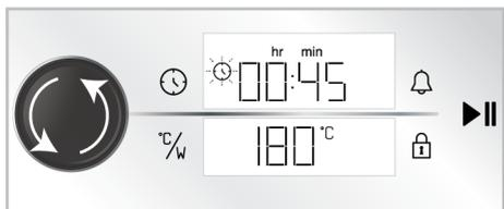
**i** Die Backzeit erhöht sich in den ersten 15 Minuten um 1 Minute und nach 15 Minuten um 5 Minuten.
