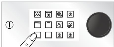
3. Auf dem Display erscheint die vordefinierte Temperatur für die von Ihnen gewählte Betriebsfunktion. Um diese Temperatur zu ändern, drücken Sie einmal auf den Bedienknopf des Backofens oder berühren Sie die Taste
