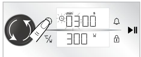
10. Stellen Sie die Backzeit in Minuten ein, indem Sie den Bedienknopf nach rechts/links drehen.
