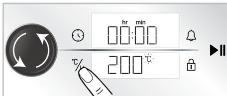
**i** Wenn Sie die Betriebsfunktion ändern, nachdem Sie die voreingestellte Temperatur der Betriebsfunktion geändert haben, wird die zuletzt eingestellte Temperatur auf dem Display angezeigt. Liegt die gewählte Temperatur jedoch nicht innerhalb des Temperaturbereichs der gewählten Betriebsfunktion, wird die höchste Temperatur für diese Betriebsfunktion angezeigt.
