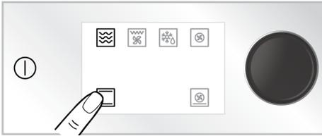
4. Auf dem Display erscheint die vordefinierte Temperatur für die von Ihnen gewählte Betriebsfunktion. Drehen Sie den Drehknopf des Backofens nach rechts/links, um diese Temperatur zu ändern.
