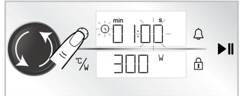
8. Stellen Sie die Backzeit in Sekunden ein, indem Sie den Bedienknopf des Backofens nach rechts/links drehen.
