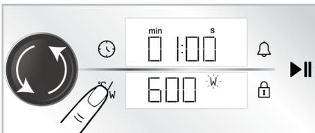
6. Um die Mikrowellen-Leistungsstufe zu ändern, drehen Sie den Bedienknopf des Backofens nach rechts/links und bestätigen Sie die Leistungseinstellung durch Berühren der Taste °C/W.
