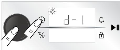
4. Stellen Sie die gewünschte Helligkeit ein, indem Sie den Bedienknopf nach rechts/links drehen.
