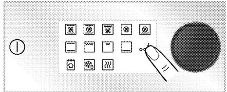
4. Auf der Temperaturanzeige erscheint die voreingestellte Temperatur für die von Ihnen gewählte Betriebsfunktion. Um diese Temperatur zu ändern, drücken Sie den Backofen-Bedienknopf oder berühren Sie die Taste °C und drehen Sie den Backofen-Bedienknopf nach rechts/links.
