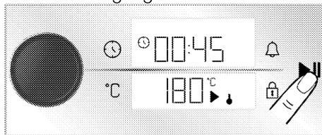
» Ihr Ofen wird sofort mit der gewählten Funktion und Temperatur in Betrieb genommen. Die eingestellte Garzeit beginnt herunterzuzählen. Die Symbole ↓ und ▶ erscheinen auf der Temperaturanzeige. Jede Stufe des Symbols ↓ leuchtet auf, wenn die Innentemperatur des Ofens die eingestellte Temperatur erreicht hat. Nachdem die eingestellte Garzeit abgelaufen ist, "End" erscheint auf der
