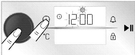
3. Stellen Sie die Stunde ein, indem Sie den Backofenregler nach rechts/links drehen und den Backofenregler einmal drücken oder die Taste
