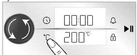
**i** Wenn Sie die Betriebsfunktion ändern, nachdem Sie die vordefinierte Temperatur für die Betriebsfunktionen geändert haben, erscheint die zuletzt eingestellte Temperatur auf dem Display. Wenn die eingestellte Temperatur jedoch nicht innerhalb des Temperaturbereichs der gewählten Betriebsfunktion liegt, erscheint die höchste einstellbare Temperatur dieser Betriebsfunktion.
