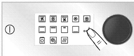
4. Auf der Temperaturanzeige erscheint die voreingestellte Temperatur für die von Ihnen gewählte Betriebsfunktion. Um diese Temperatur zu ändern, drücken Sie den Backofen-Bedienknopf oder berühren Sie die Taste °C und drehen Sie den Backofen-Bedienknopf nach rechts/links.
