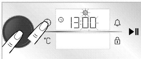
4. Stellen Sie die Minute ein, indem Sie den Backofenregler nach rechts/links drehen. Bestätigen Sie die Zeiteinstellung, indem Sie auf den Regler des Backofens drücken oder die Taste
