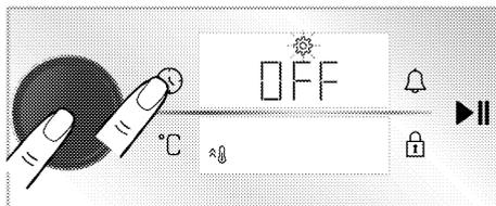
4. Drehen Sie den Backofenregler nach rechts/links, um die „AUS“-Einstellung, die auf dem Zeit-/Uhr-Bildschirm angezeigt wird, auf „EIN“ zu ändern.
