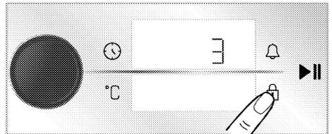
» Der 3-2-1 Countdown wird angezeigt. Das Symbol ① erscheint auf dem Zeit-/Uhr-Bildschirm und die Tastensperre ist aktiviert. Wenn bei eingestellter Tastensperre eine beliebige Taste berührt oder der Backofenregler gedrückt wird, ertönt ein akustisches Signal und das Symbol ① blinkt.
