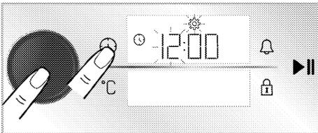
3. Stellen Sie die Stunde ein, indem Sie den Backofenregler nach rechts/links drehen und den Backofenregler einmal drücken oder die Taste
