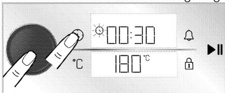
**i** Nach der Einstellung der Betriebsfunktion und Temperatur wird die Garzeit 30 Minuten durch Berühren der Taste ⌚ oder durch direktes Drücken auf den Backofenregler eingestellt, um die Garzeit schnell einzustellen und die Zeit durch Drehen des Backofen-Bedienknopfes nach rechts/links zu ändern.
