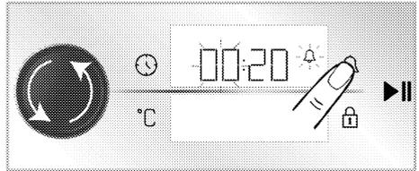
3. Stellen Sie die Stunde ein, indem Sie den Backofen-Regler nach rechts/links drehen. Bestätigen Sie die Zeiteinstellung, indem Sie auf den Regler des Backofens drücken oder die Taste
