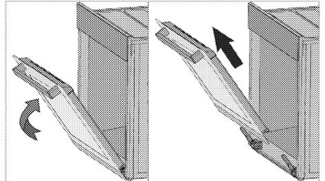
4. Ziehen Sie die halb geöffnete Tür nach oben, um sie aus dem rechten und linken Scharnier und zu entfernen.
