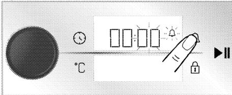
2. Stellen Sie die Minute ein, indem Sie den Backofen-Regler nach rechts/links drehen und die Taste
