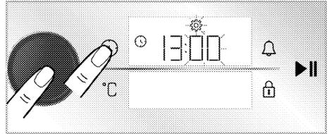
4. Stellen Sie die Minute ein, indem Sie den Backofenregler nach rechts/links drehen. Bestätigen Sie die Zeiteinstellung, indem Sie auf den Regler des Backofens drücken oder die Taste
