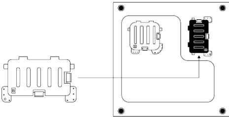
Legen Sie die Laschen von Abdeckung B gegen die untere Platte. Schließen Sie die Montage ab, indem Sie die Abdeckung drehen.
