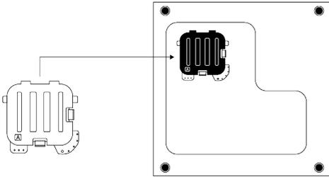
Kippen Sie die Maschine leicht nach hinten. Legen Sie die Laschen von Abdeckung A gegen die untere Platte. Schließen Sie die Montage ab, indem Sie die Abdeckung drehen.
