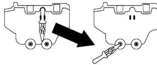
2. Entfernen Sie den Ablassstift, der sich an der Rückseite der Schublade befindet, aus seinem Steckplatz.
