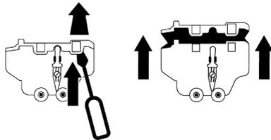
7. Die Führungen, die die obere Abdeckung der Waschmittelschublade halten, werden mit einem Schlitzschraubendreher entfernt (insgesamt 6 Führungen, je zwei rechts, links und hinten in der Schublade) und das Innere der Schublade wird gewaschen.
