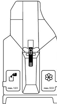
2. Um Flüssigwaschmittel (links) und Weichspüler (rechts) einzufüllen, öffnen Sie den Deckel des entsprechenden Tanks, indem Sie ihn wie in der Abbildung gezeigt nach oben ziehen.
