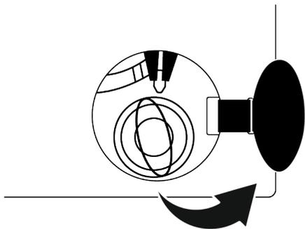
3. Ziehen Sie den Notgriff der Ladetür mit einem Werkzeug nach unten und lassen Sie ihn los. Öffnen Sie die Beladetür.
