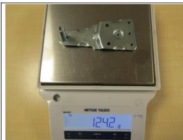
Верхний шарнир после испытаний
