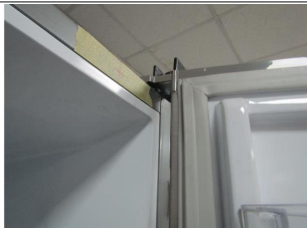
Средний шарнир после испытаний
