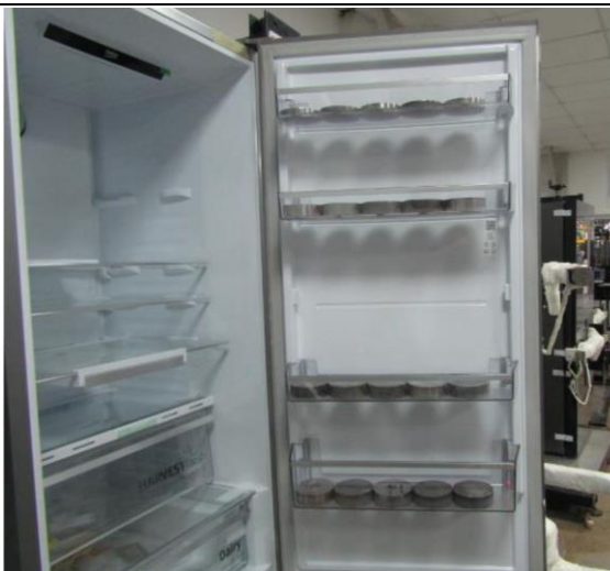
Масса верхнего шарнира после испытаний
