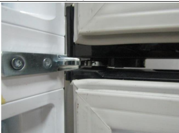
Средний шарнир после испытаний
