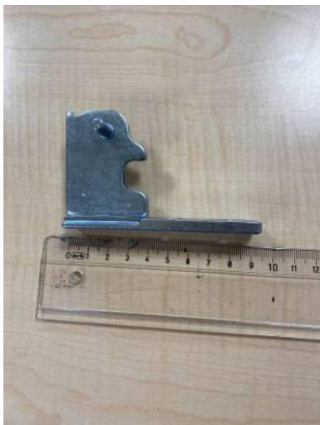
Верхний шарнир до испытаний
