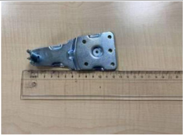
Верхний шарнир до испытаний
