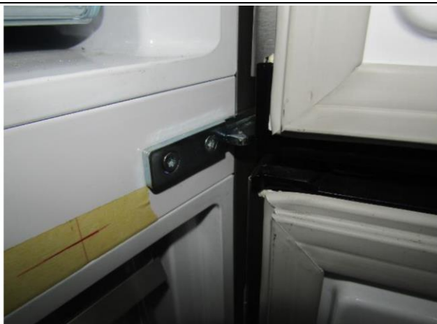
Нижний шарнир после испытаний
