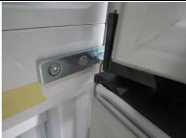
Пластиковый ограничитель до испытаний
