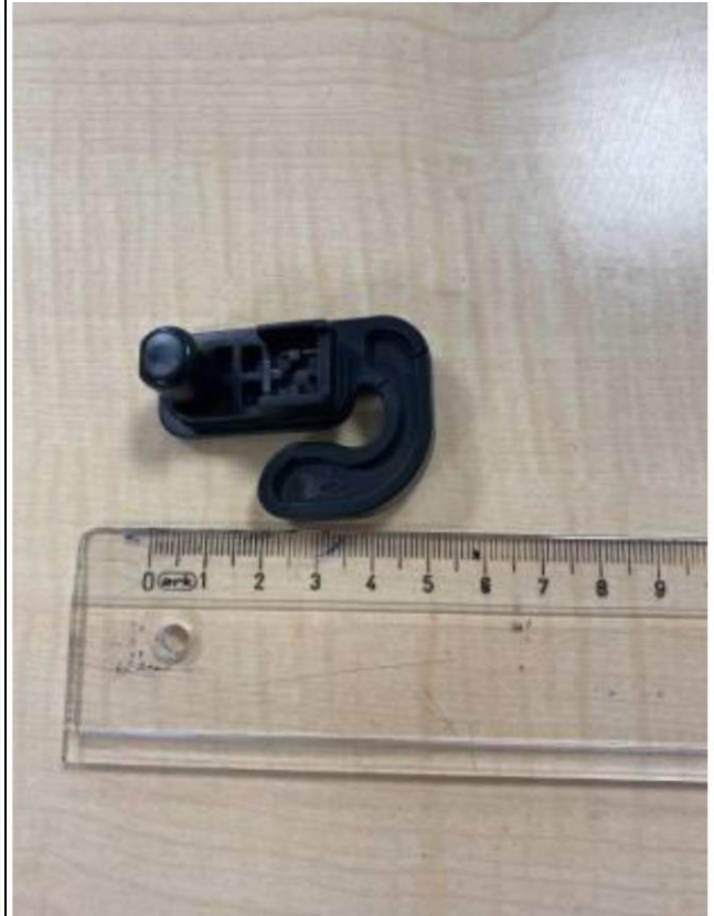
Пластиковый ограничитель до испытаний
