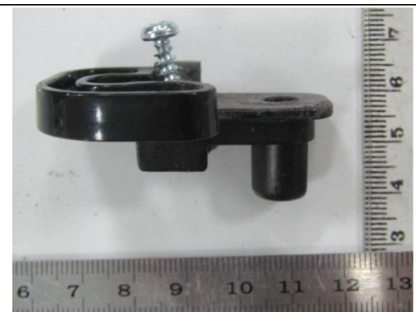
Пластиковый ограничитель после испытаний
