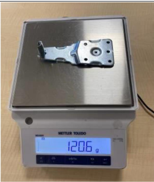
Масса верхнего шарнира до испытаний
