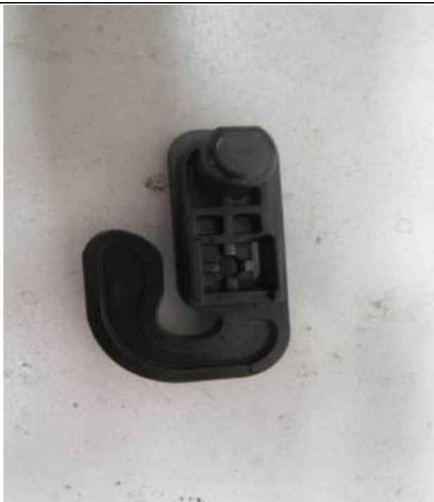
Пластиковый ограничитель до испытаний
