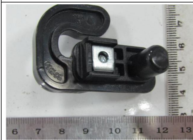
Пластиковый ограничитель после испытаний
