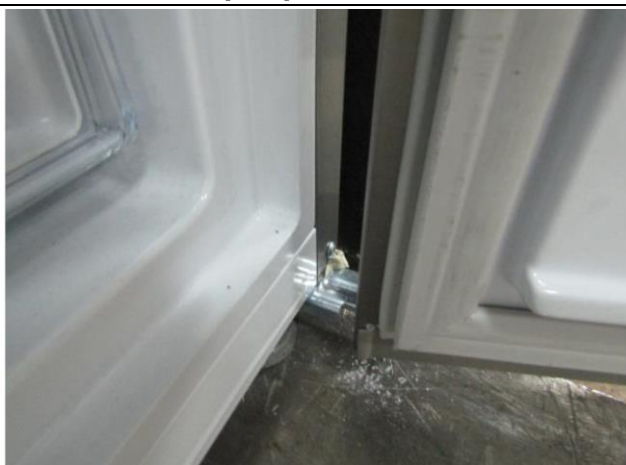
Нижний шарнир после испытаний
