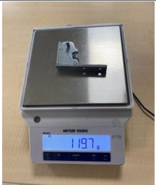
Масса пластикового ограничителя до испытаний
