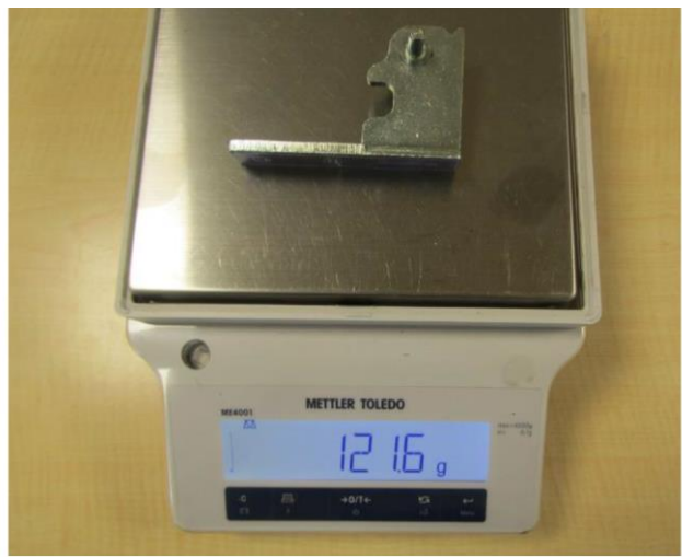
Масса пластикового ограничителя после испытаний
