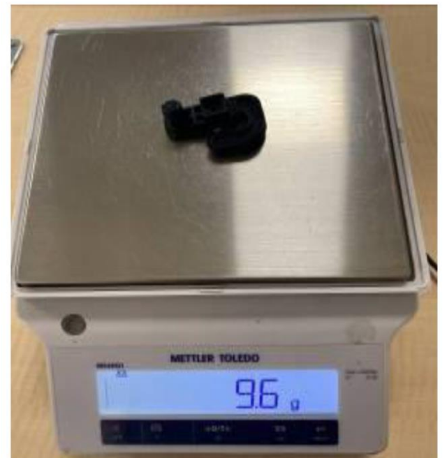
Масса пластикового ограничителя до испытаний
